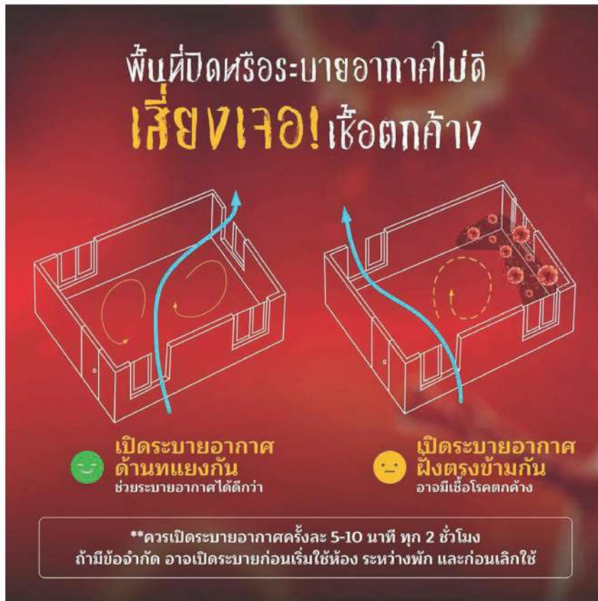
รูปภาพที่ 2 แสดงตัวอย่างการเปิดประตูระบายอากาศห้องภายในอาคาร
