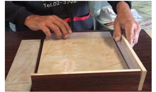
6. นำไม้แผ่นอัดมาประกบเป็นสี่เหลี่ยมผืนผ้า
